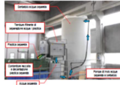
Immagine esemplificativa processo di separazione acqua / plastica
